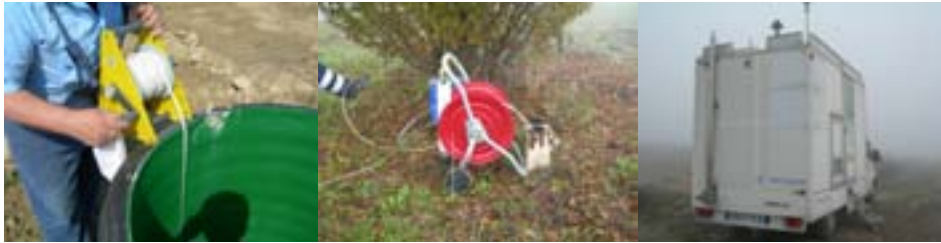
Misurazione dei livelli di percolato nei pozzi
