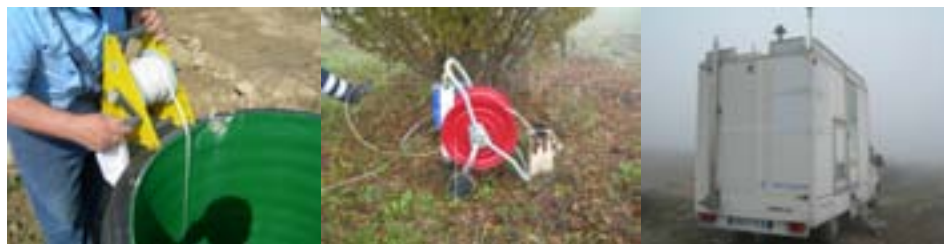
Misurazione dei livelli di percolato nei pozzi
