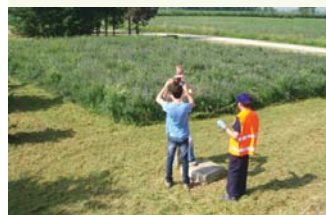
Posizionamento dei radielli per l'analisi della qualità dell'aria
