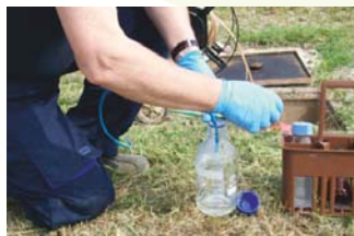
Campionamento acque di falda: fasi di prelievo
